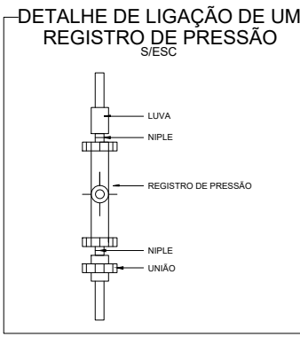
DETALHE DE LIGAÇÃO DE UM REGISTRO DE PRESSÃO
