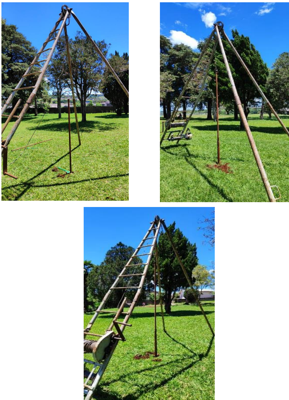
Figura 3 – Levantamento em campo – SPT 01 ao SPT 03, fonte: do autor, 2024.
