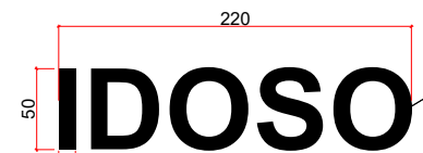
DETALHE SINALIZAÇÃO HORIZONTAL Escala: 1/50 medidas em cm
