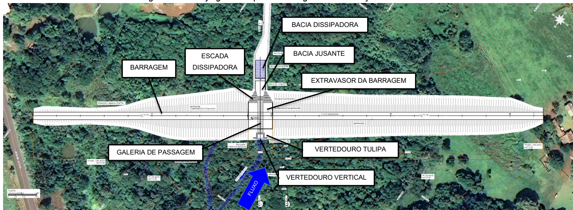
Figura 2 – Arranjo geral em planta Barragem de Contenção de Enchentes.
